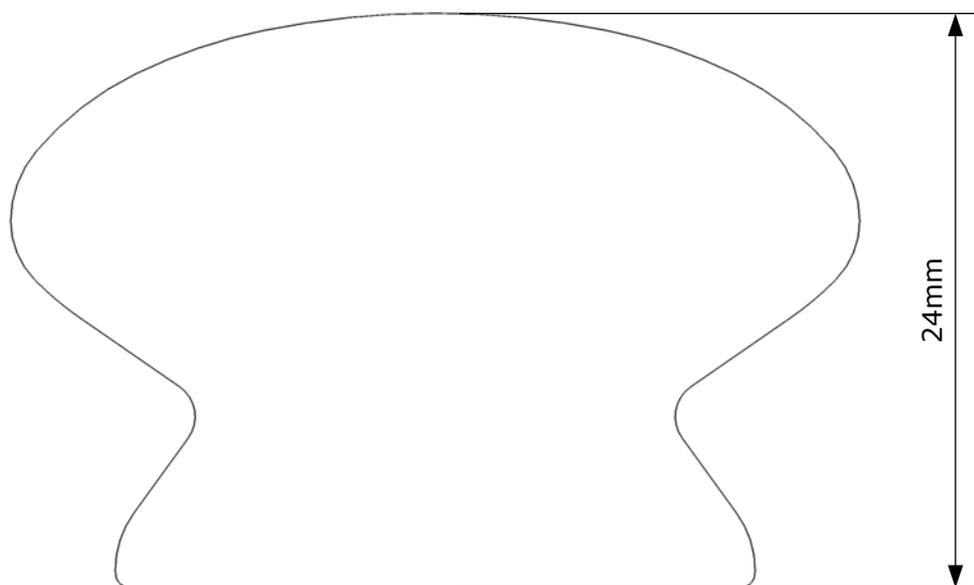
Estos pomos se fabrican en los siguientes diámetros: 40mm, 35mm, 30mm y 25mm.
