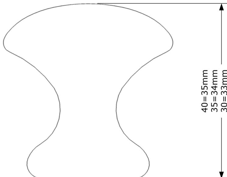
Estos pomos se fabrican en los siguientes diametros: 40mm, 35mm y 30mm.
