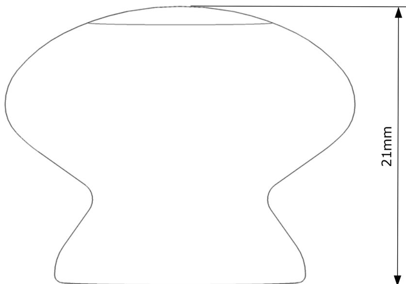
Este pomo se fabrica con un diametro de 30mm.
