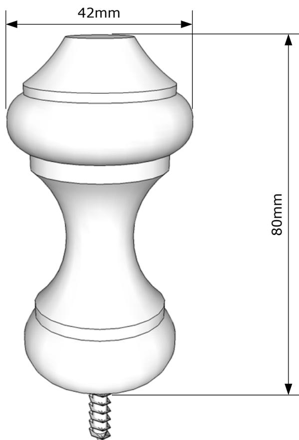
Este pomo se fabrica de 42mm de diametro por 80mm de altura.
