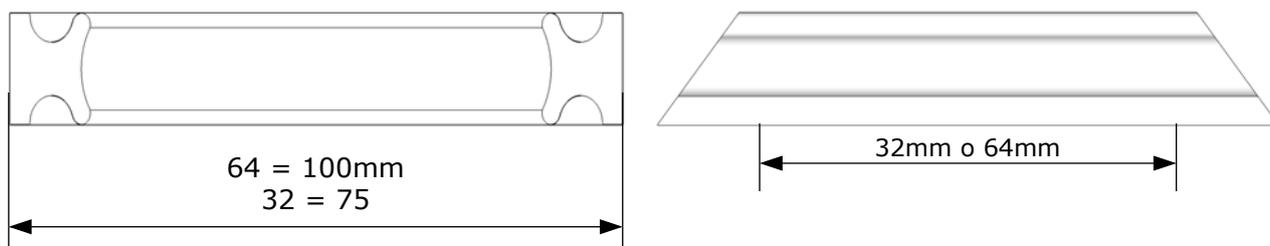
Estos tiradores se fabrican con 32mm y 64mm de distancia entre centros. Bajo pedido se pueden fabricar mas largos y con la distancia entre centros que se pida.
